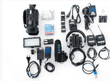
Der Medienrucksack 1 ist ein Komplettsset zur semiprofessionellen Videoproduktion. Das Set umfasst neben dem Camcorder ein LED-Panel, ein Richtmikrofon und eine Funkstrecke mit Ansteckmikrofon.
