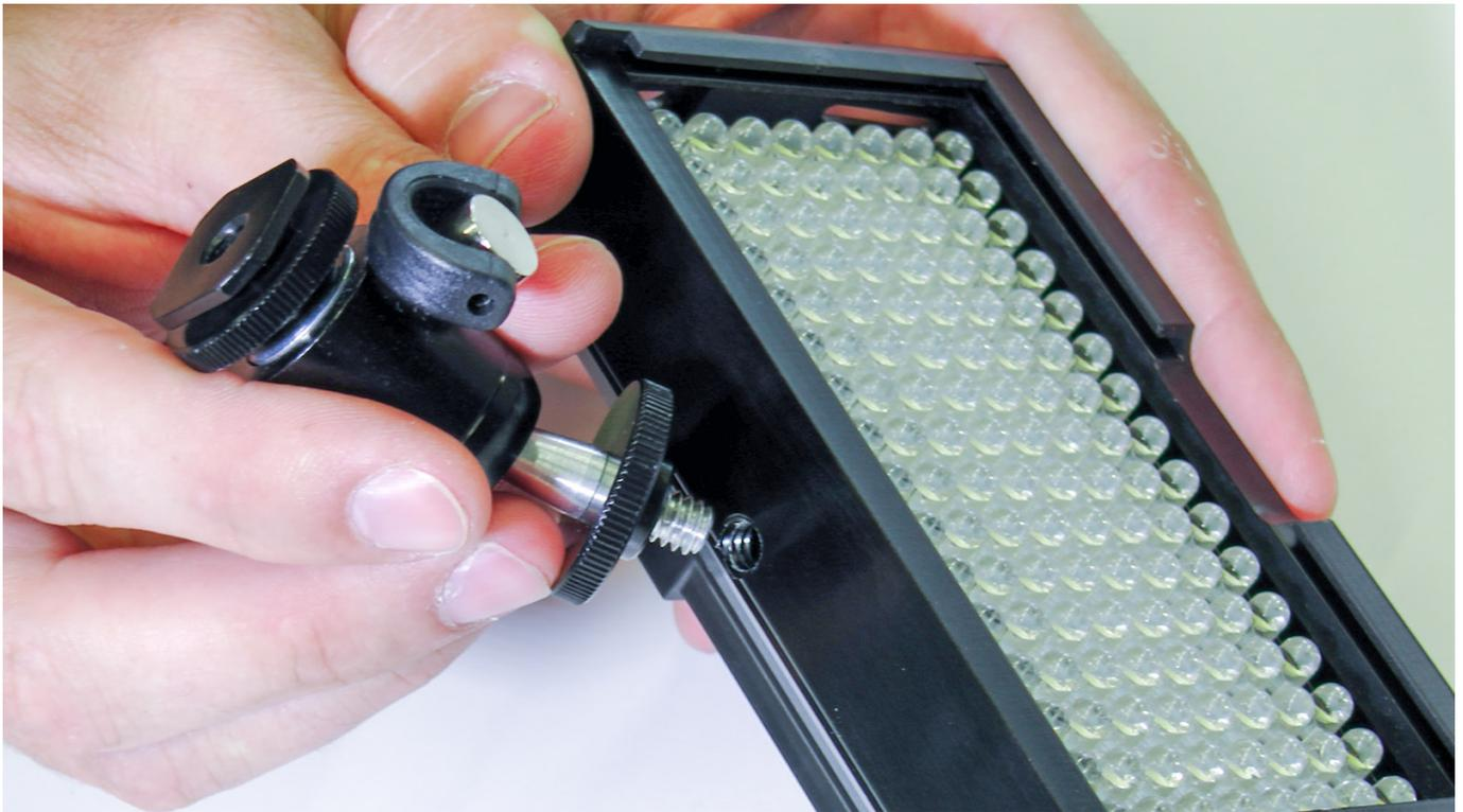
Schrauben sie den Adapter für den Schlitten an das LED-Panel.
