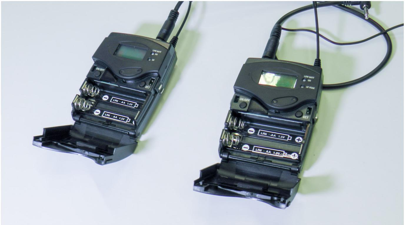
Öffnen Sie die Batteriekappen der Funkstrecken...
