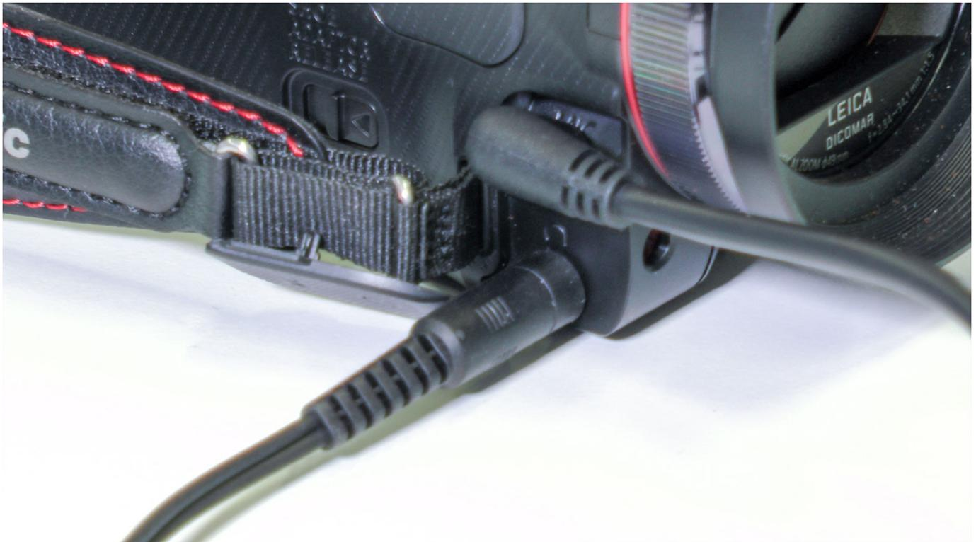
Verbinden Sie dazu den Kopfhörer mit dem anderen Klinkenanschluss der Kamera.
