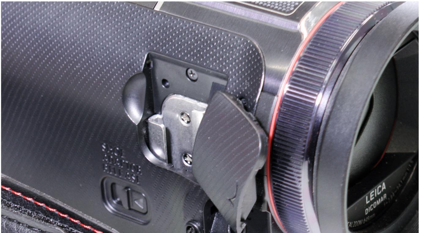
Öffnen Sie die Plastiklasche an der Kamera für den montierbaren Schlitten.
