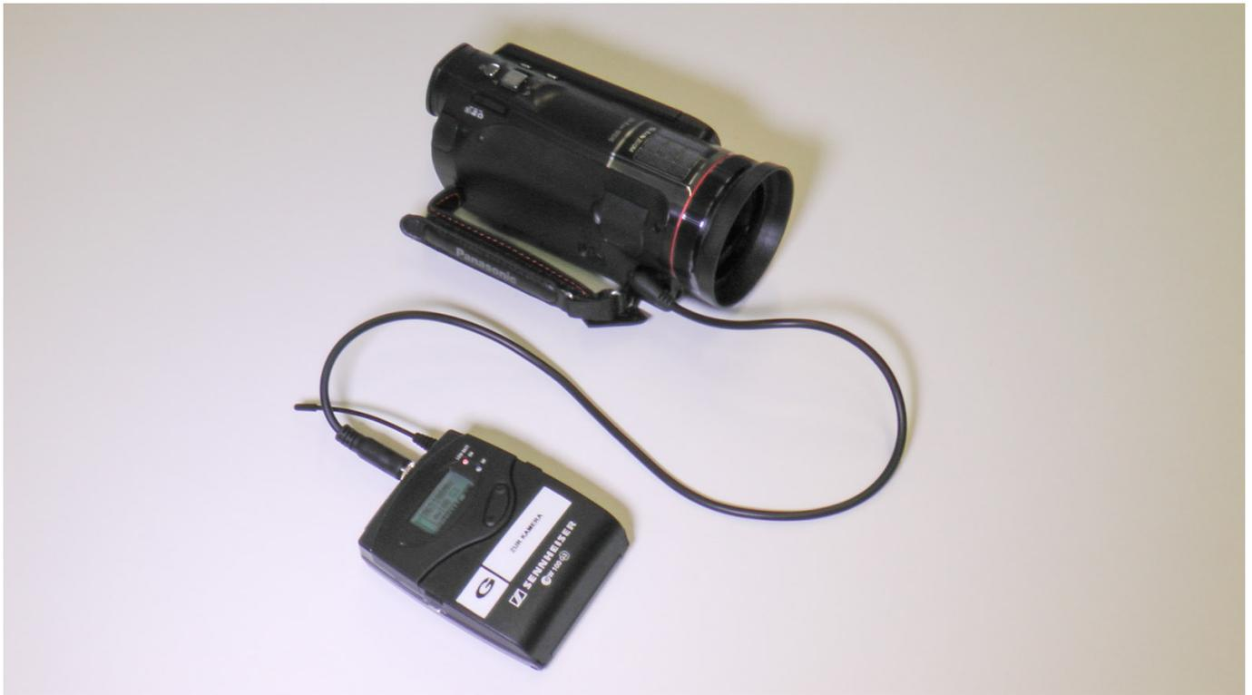
Ihre Funkstrecke ist jetzt mit der Kamera verbunden und das Audio vom Sender (dem Mikrofon) wird übertragen.
