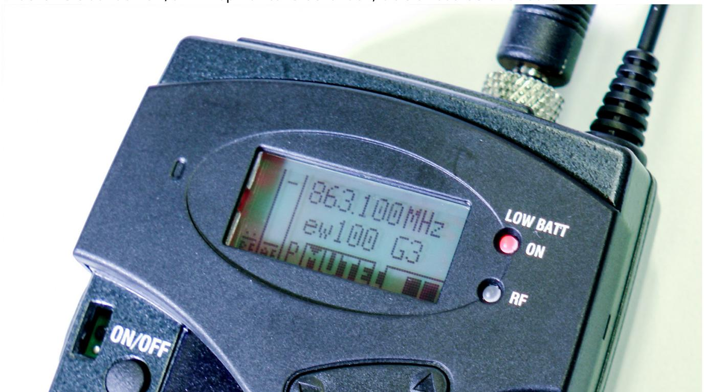
Ist das Gerät eingeschaltet, erscheint ein Display. Die Geräte sind voreingestellt und sollten auf den jeweiligen Displays die gleiche Sendefrequenz anzeigen.
