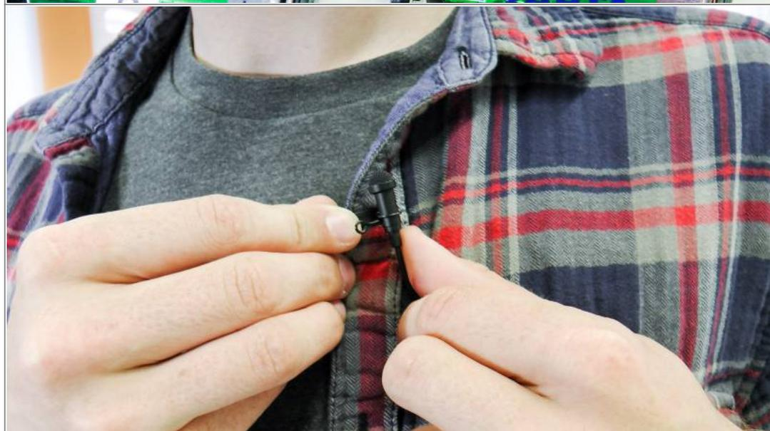
Bringen Sie das Lavalier-Mikrofon an einem Hemd, einer Krawatte oder einer Falte im Shirt an. Achten Sie darauf, dass das Mikrofon nicht mit Stoff in Berührung kommt (Störgeräusche, Kratzen). Das Mikrofon sollte in etwa auf der Höhe (Entfernung zum Mund) wie im Beispielbild angebracht sein.
