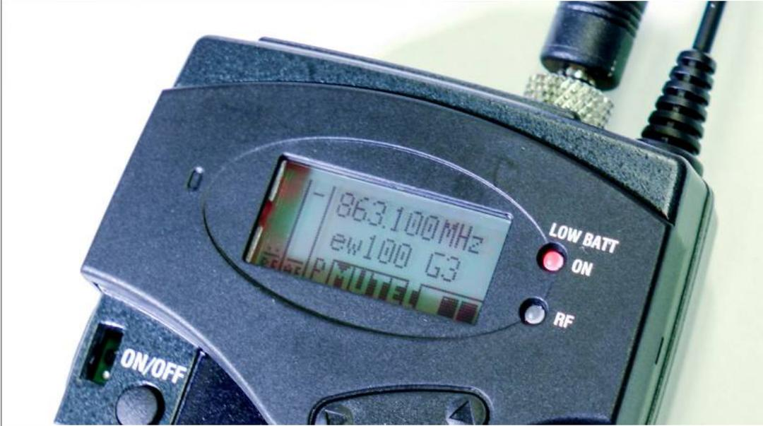
Ist das Gerät eingeschaltet, erscheint ein Display. Die Geräte sind voreingestellt und sollten bei beiden Geräten die gleiche Sendefrequenz anzeigen. Hier im Beispielbild: 863.100 MHz
