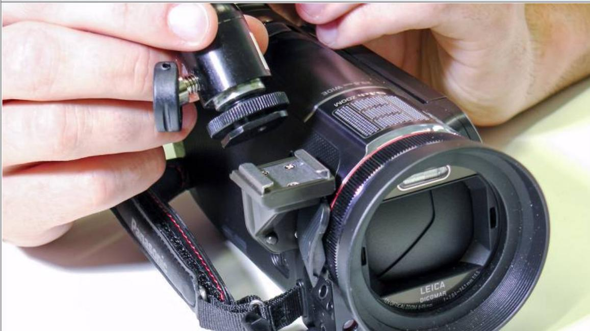
Setzen Sie das Licht mit dem Schlittenadapter auf den Schlitten an der Kamera.
