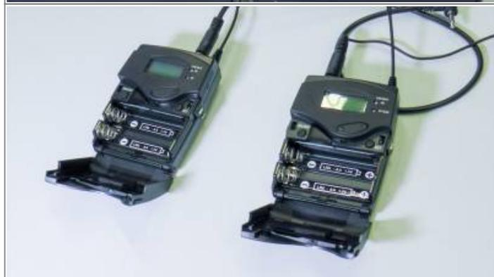
Öffnen Sie die Batterieklappen der Funkstrecken...
