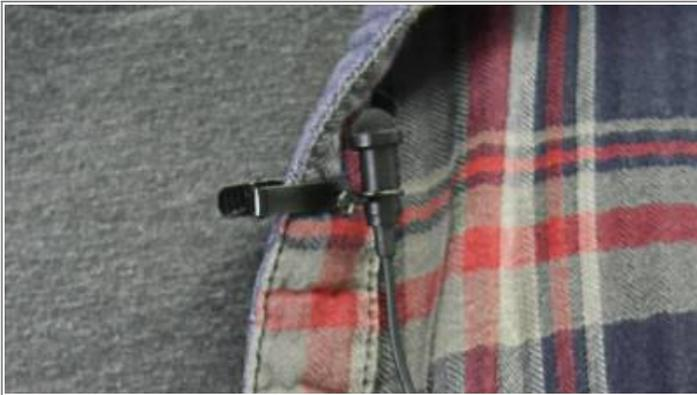
Das Kabel können sie entweder einfach runterhängen lassen oder in einer schöneren Variante in der Kleidung verstecken.
