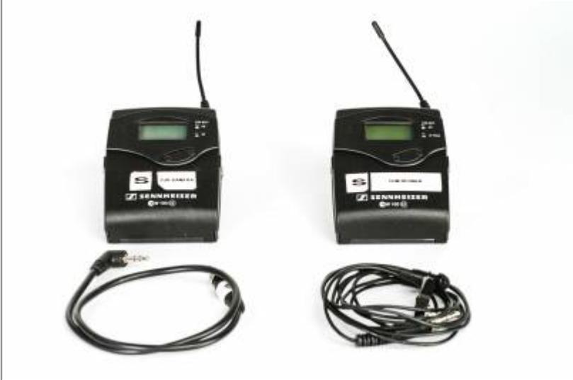
Im Medienrucksack finden Sie eine zuverlässige und bewährte Technik um eine Person perfekt aufzunehmen. Die Funkstrecke der Marke SENNHEISER besitzt einen Sender, einen Empfänger, ein Mikrophon und ein Anschlusskabel zur Kamera.
