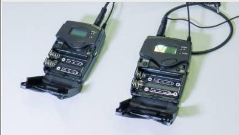
Öffnen Sie die Batteriekappen der Funkstrecken
