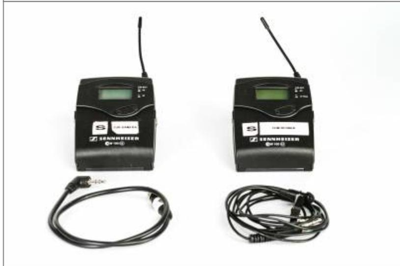
Im Medienrucksack finden Sie eine zuverlässige und bewährte Technik um eine Person perfekt aufzunehmen. Die Funkstrecke der Marke SENNHEISER besitzt einen Sender, einen Empfänger, ein Mikrofon und ein Anschlusskabel zur Kamera.
